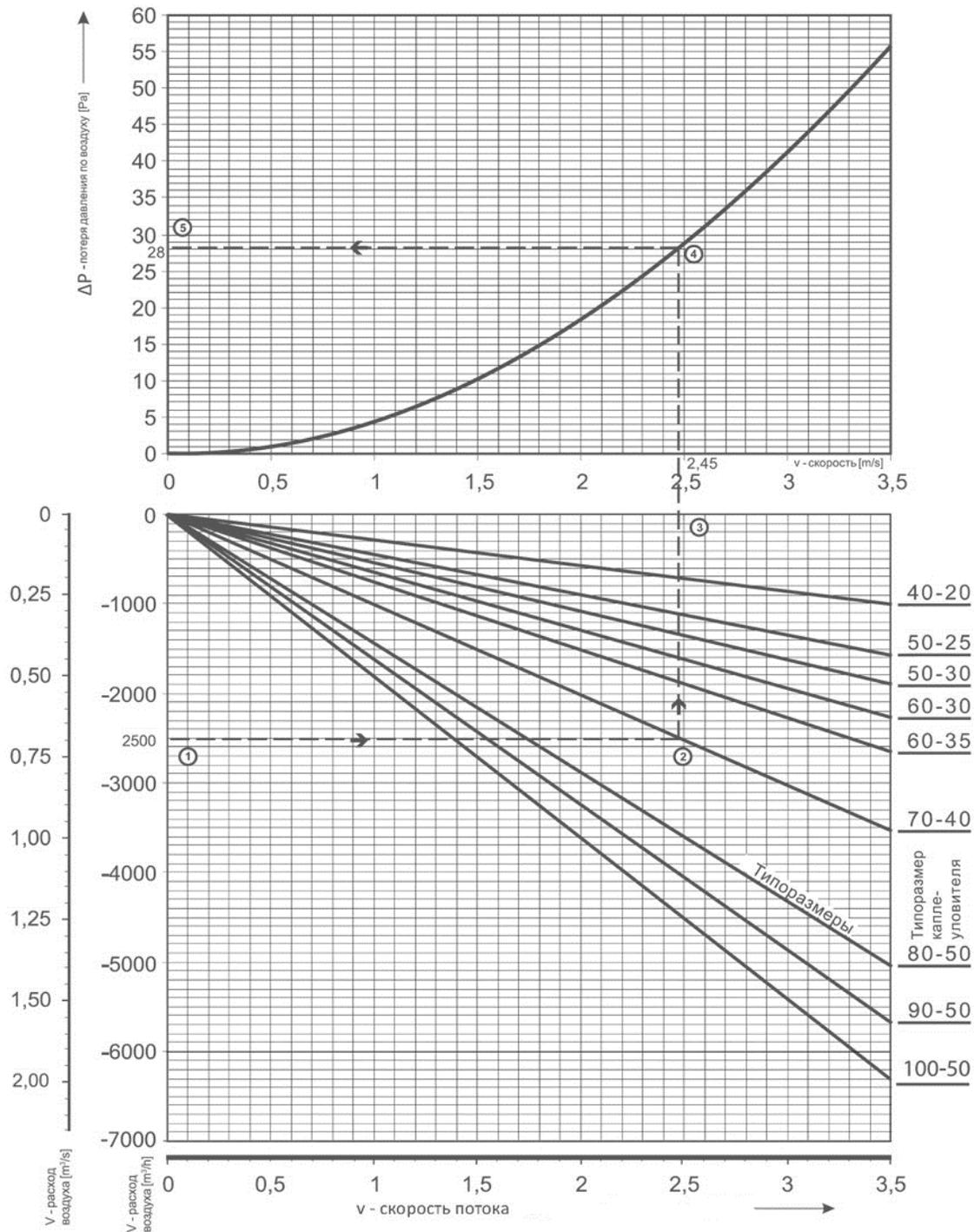
Для заданного расхода воздуха (1) по нижнему графику определить скорость потока (3) в свободном сечении каплеуловителя (2). Типоразмер каплеуловителя соответствует размеру канального прохода увлажнителя. По найденной скорости по верхнему графику определить соответствующие потери давления по воздуху (5).
